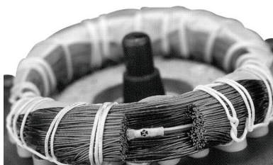
그림 45 권선에 적용된 PTC 센서
